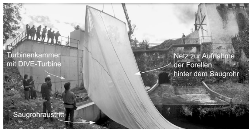
Bild 1: Kraftwerk Crampagna: a) generelle Anordnung, b) Versuchsaufbau bei den Freilandversuchen zur Fischverträglichkeit an der Dive-Turbine im Juni 2016, Unterwasseransicht (Quelle: Dive Turbinen GmbH und Co. KG)
