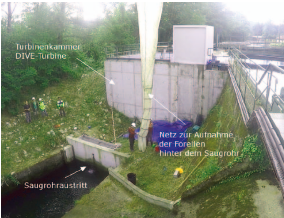
Abb. 8: Versuchsaufbau der ersten Freilanduntersuchungen. Die Forellen wurden direkt in den Leitapparat der Turbine eingebracht. Nach der Turbinenpassage wurden die Forellen hinter dem Saugrohr in einem Netz aufgefangen und zur Untersuchung in ein Hälterungsbecken eingebracht.
