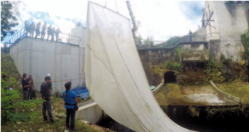
Abb. 7: Freilanduntersuchungen: Die Turbinenkammer befindet sich links im Bild. Der Hamen, in dem die Forellen nach der Turbinenpassage wieder gefangen werden, wird per Kran hinter das Saugrohr platziert.
